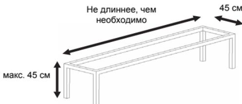
**Рисунок 2.3 Мост для временных трасс**
