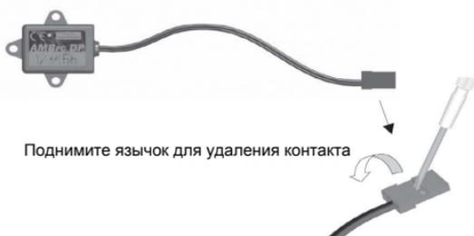
Рисунок 2.5 Установка транспондера MYLAPS RC DP
